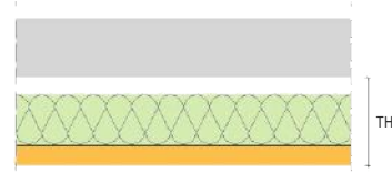
Z wypełnieniem z wełną skalną
